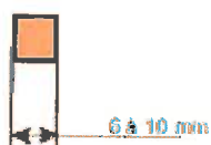
Carré mâle Largeur progressive de 6 à 10 mm Profondeur de 20 mm
