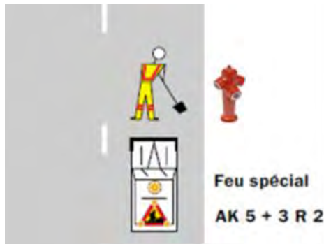
Cas des contrôles réalisés sur chaussées sous circulation avec visibilité.
